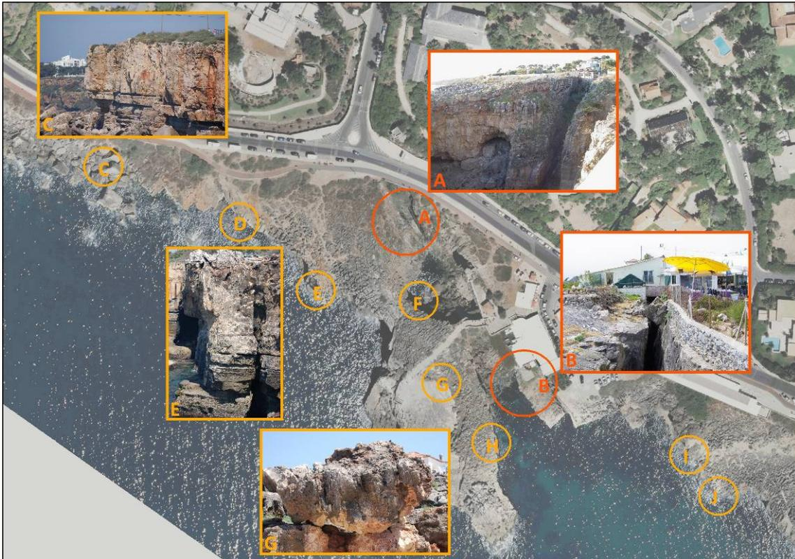
Figura 7 – Áreas com filões erodidos (a vermelho) e áreas com indícios de instabilidade de blocos (a laranja). (Fonte das imagens B, C, E e G: Instituto Hidrográfico, 2006)
